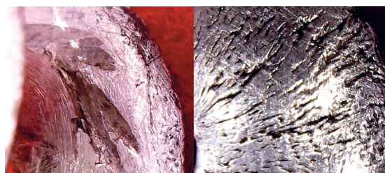
Fotografía 49. Detalle de los golpes en la pieza para lograr su unión.
