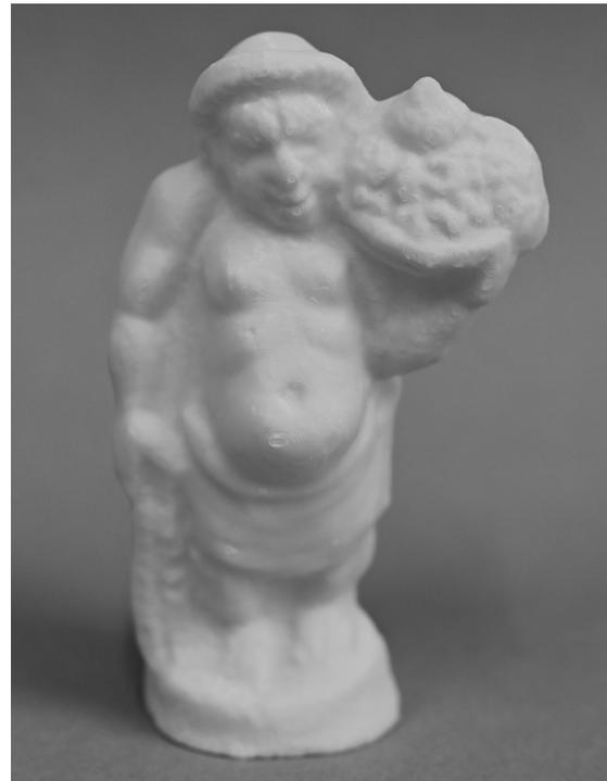
**Abb. 2:** 3D-Druck der durch das SfM-Verfahren eingescannten Terrakottafigur
