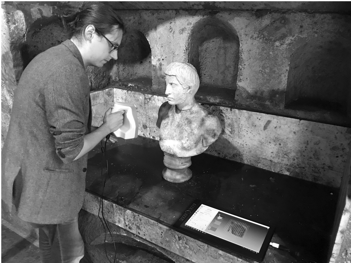
Abb. 4: Die Büsten aus der Grabkammer wurden mit Hilfe eines Handlaserscanners erfasst. Hier die Erfassung und Verarbeitung der männlichen Büste
