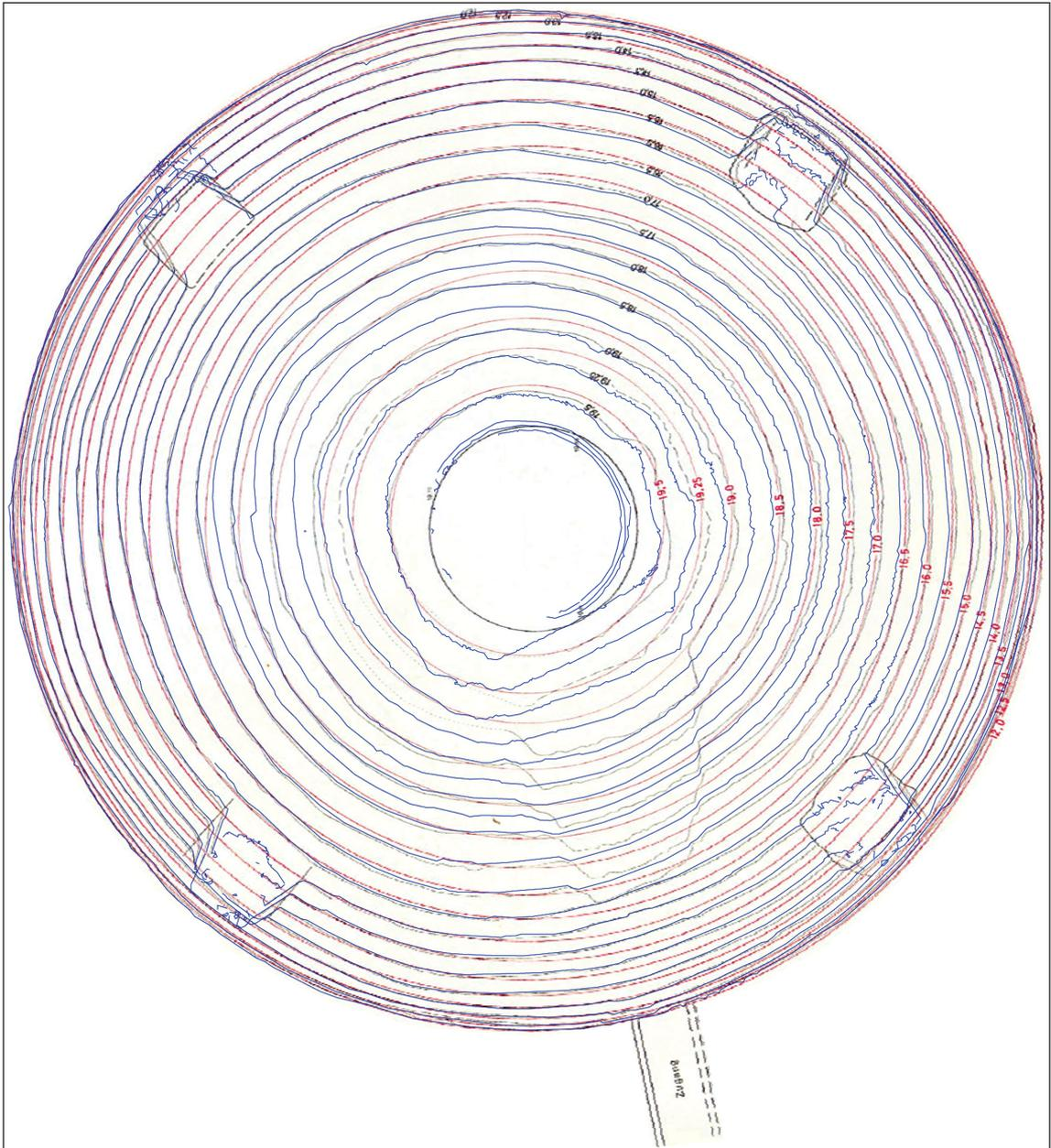
**Abb. 18:** Vergleich der Horizontalschnitte: Horizontalschnitte nach der Stereophotogrammetrie (schwarz), arithmetisch gemittelte Kreise (Sollform) aus der Stereophotogrammetrie (rot) und Horizontalschnitte aus dem Laserscan (blau).
