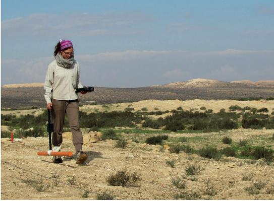
Abb. 11: Elusa, Elektromagnetisches Induktionsverfahren.
