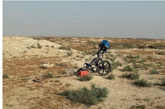
**Abb. 4:** Elusa, Bodenradar im Bereich der südwestlichen Messfläche.
