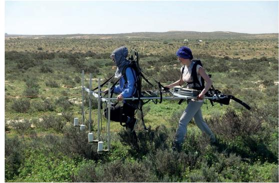
Abb. 2: Elusa, neu entwickeltes Tragegestell für die Magnetik.
