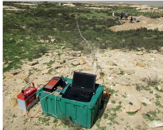
**Abb. 7:** Elusa, Elektrische Widerstandstomographie.
