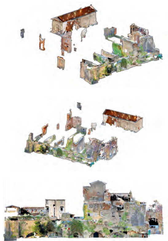
Abb. 3: Ansichten der 'Punktwolke' des Laserscans im Quartier Cellomaio.
