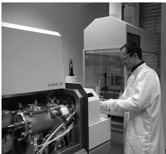
Abb. 2: Arbeiten am Massenspektrometer zur Bestimmung der Bleiisotopen- und chemischen Zusammensetzung.
